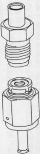
图 2-3 无定位 VCR 垫圈的 VCR 接头安装示意图
