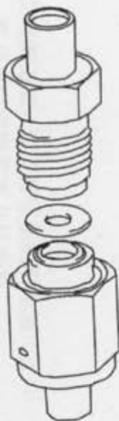
图 2-3 无定位 VCR 垫圈的 VCR 接头安装示意图
